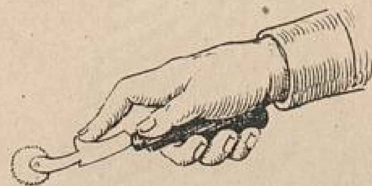
Abb. 16. Die richtige Handhabung des Kopierrädchens. (Durch das Eindrücken des Zahnrades des Kopierrädchens in das Papier bleibt eine feine Lochlinie zurück.)
