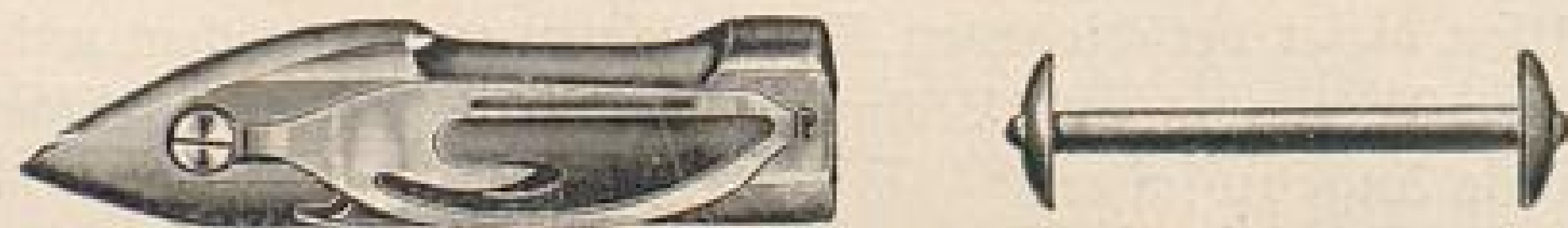
Abb. 122. Schiffchen und Spule der Schwingschiffchen-Tretmaschine.
