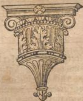
Figur der Kragfer oder Kragstein so in die Nauen eyngelegt werdt / die Bögen der Gewelb zu tragen.
