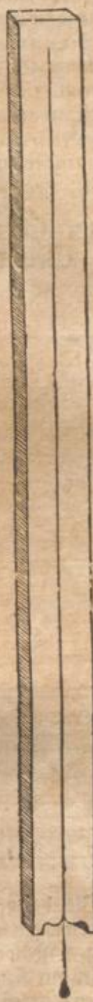
Figur / wie man bestehend durch ein gemein Nischschloß erkennt mög / ob ein Wand in d' Nischschaur oder Bagrecht steht.
