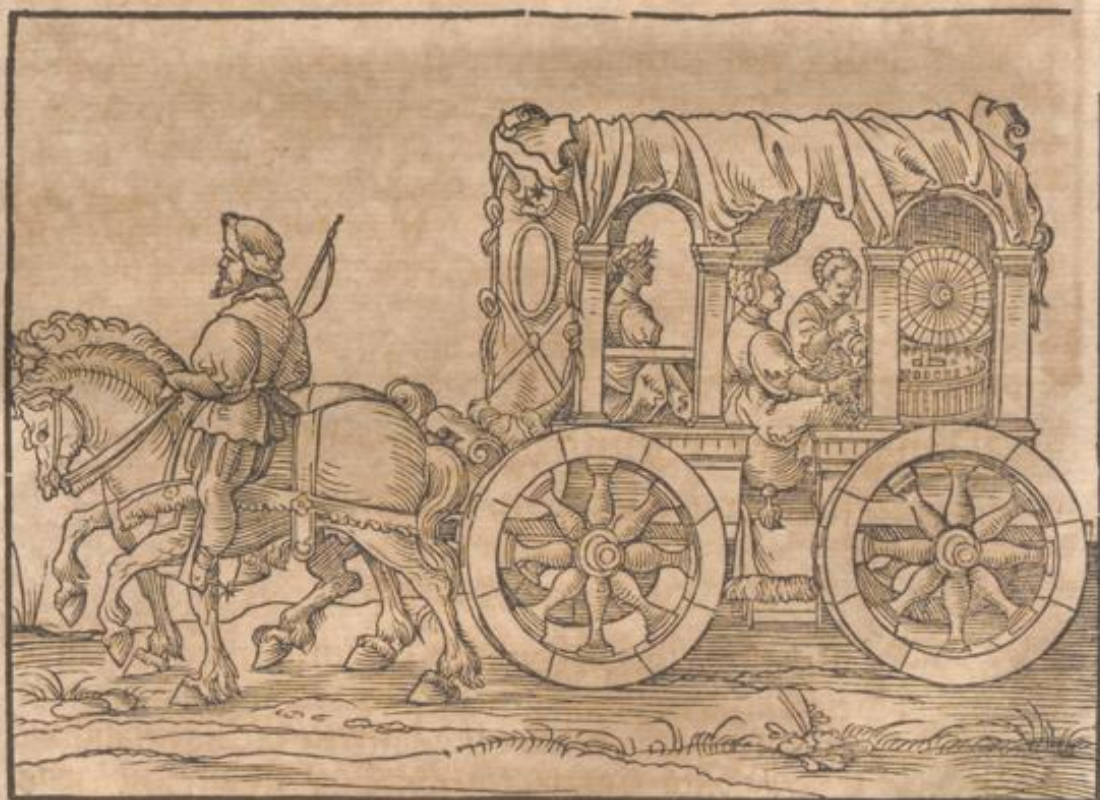
Figur wie man auff einem Wagen durch künstliche Machination den Weg messen soll / nach der meynung Vitruuij.
