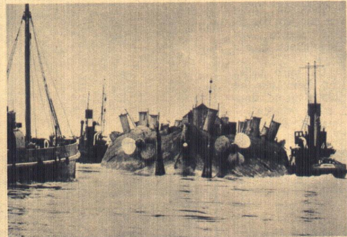
Der bei Scapa Flow gehobene Kreuzer 'Prinzregent Luitpold' wird verschrotet. Drei Schlepper werden das gehobene Schiff nach Rosyth bringen. Ein Teil der Arbeitsmannschaft wurde in dem Kieloben gedrehten Schiffkörper 'einquartiert', in den man zu diesem Zweck Öffnungen geschnitten hat, so daß die Insassen die Decke der Offiziersmesse als Boden unter sich haben werden. Als letztes der Schiffe, die den heldenhaften Untergang bei Scapa Flow gefunden haben, soll 'Von der Lamm' ab-geschleppt werden.
