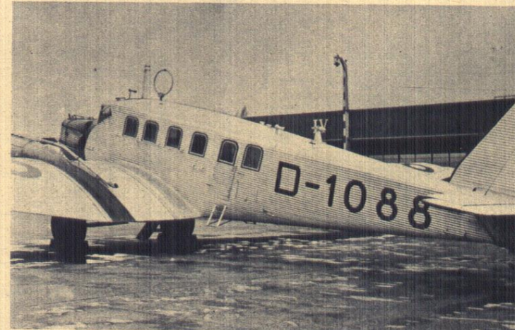
Verkehrsflugzeug mit Telefunken-Peiler und Sende-Antenne.
