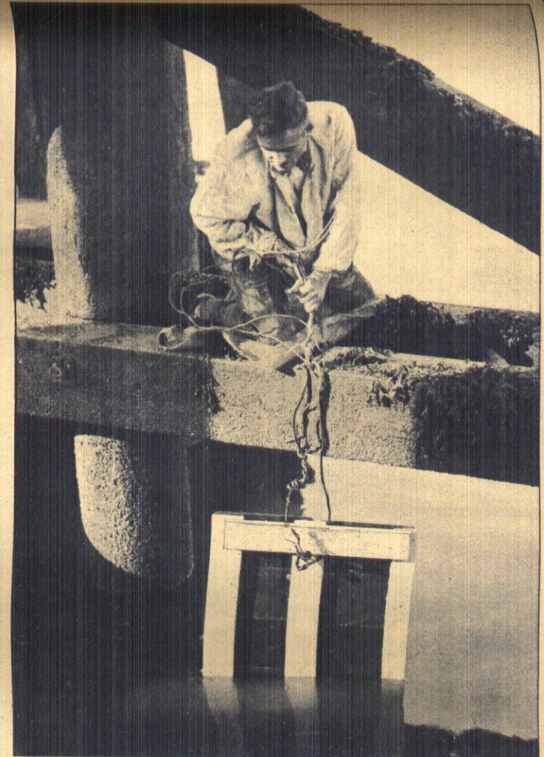
Versuchsplatten, die mit besonderen Anstrichen versehen sind, werden ins Meer gehängt, nach etwa vier Wochen wieder herausgenommen und auf den angesetzten Bewuchs hin untersucht.
