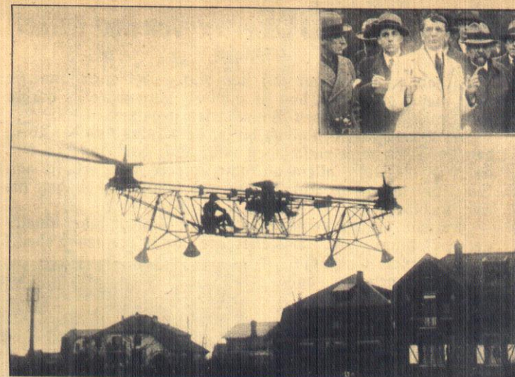
Ein seltsames Windmühlenflugzeug wurde Vertretern der belgischen Luftfahrt in Brüssel von seinem Konstrukteur, Ingenieur Florinne, vorgeführt. An Stelle der üblichen Räder hat dieses „Flugzeug“ vier Füße, da es senkrecht starten und landen kann. Das Flugzeug in der Luft. Rechts oben: Der Erfinder Florinne erklärt die Konstruktion.
