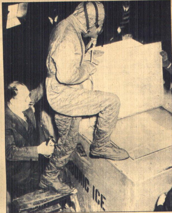
Der amerikanische Forscher Mark Rudge plant einen neuen Stratosphärenflug in bisher unerreichte Höhen. Um seine Schutzkleidung auf ihre Kältebeständigkeit zu prüfen, hielt er sich eine Zeitlang in einem Eistank auf, in dem eine Temperatur von minus 110 Grad Fahrenheit herrschte, die wohl auch von der Stratosphärentemperatur nicht übertroffen werden kann.
