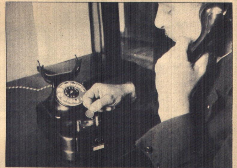
Die Reichspost hat anstelle der Wandapparate neuerdings auch einen Tisch-Mäzgersprecher eingeführt, der sich zur Verwendung in Privatwohnungen eignet. Von diesen Familien-Mäzgersprechern kann auch das Fern- und Schnellamt angerufen werden. Der Teilnehmer leert den Mäzgerhalter selbst, während die Gesprächsgebühren wie üblich vom Amt aus in Rechnung gestellt werden.
