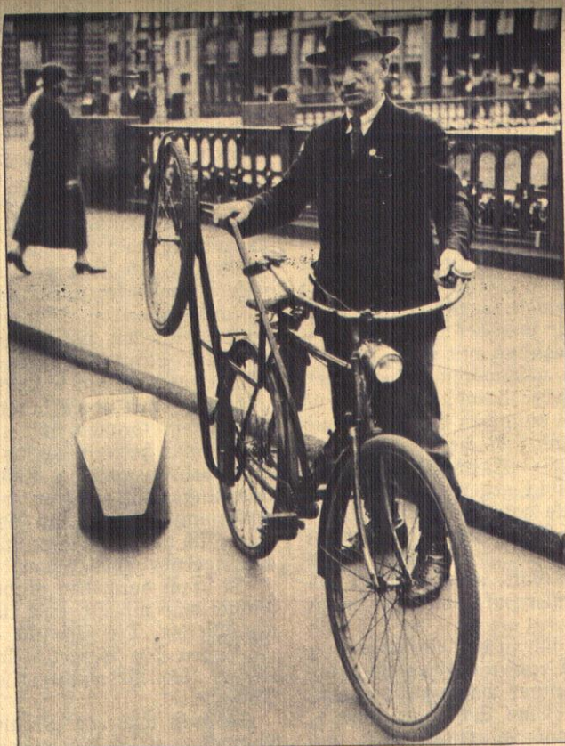
Das zusammenlegbare Dreirad. Ein Hamburger Erfinder hat dieses Fahrrad konstruiert, das mit einer Beinwagenvorrichtung versehen ist. Ein Handgriff genügt (siehe Bild), um das Fahrgestell des Beinwagens mit dem dritten Rad hochzuklappen. So kann man dann das Rad bequem in die Wohnung tragen. Im ausgeklappten Zustande trägt das Fahrgestell eine Limousine für die Kinder oder ein Gefest für Lasten. Hoffmann
