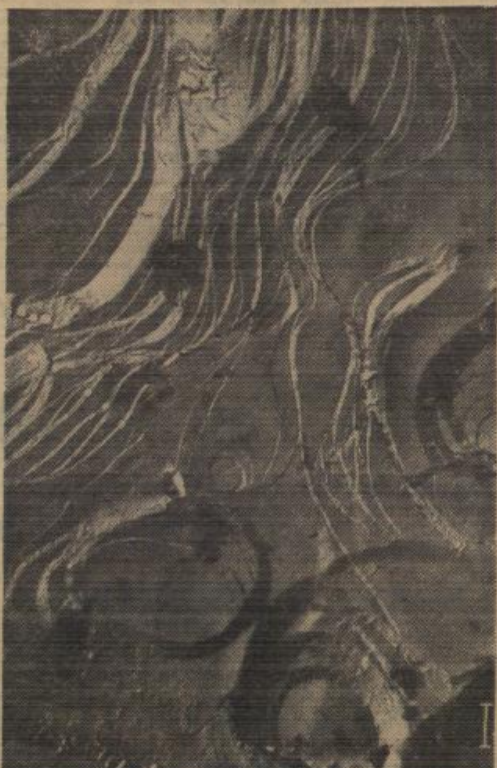
Die Aufnahme zeigt die Oberfläche von angeschliffenem Koks (Lackabdruck) als eindrucksvolles Beispiel für das Auflösungsvermögen des Elektronenmikroskops.
