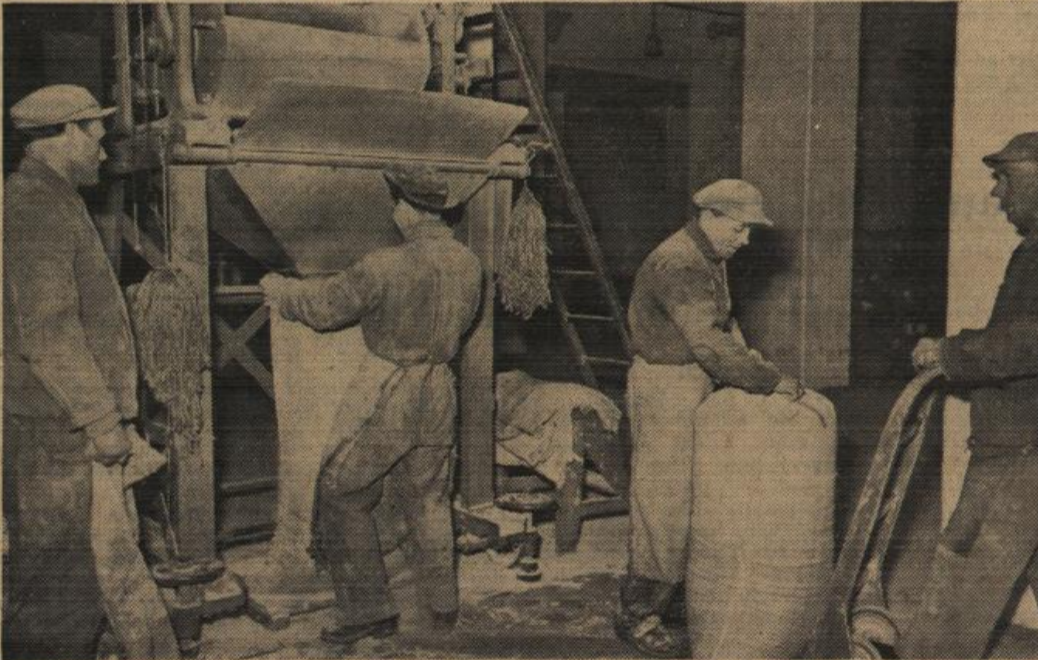
Mit einer Waage gekoppelte Sackabfüllmaschine geben automatisch 100 kg Getreide in die Säcke
