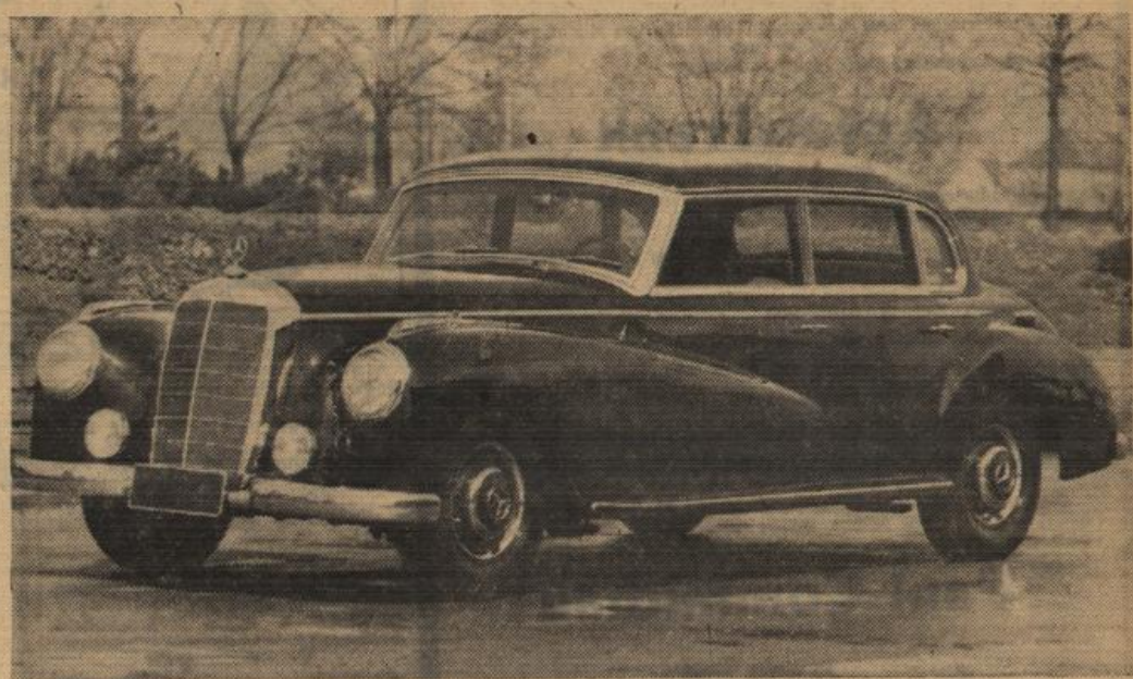
Der neue Mercedes Typ 300 115 PS, 3-L-Sechszylindermotor, kopfgesteuert, mit 2996 ccm Hubraum, Spitzengeschwindigkeit 155 km/h, lieferbar als fünf- bis sechsstufige Limousine und als Cabriolet. Je nach Belastung kann eine Zusatzfederung eingeschaltet werden.
