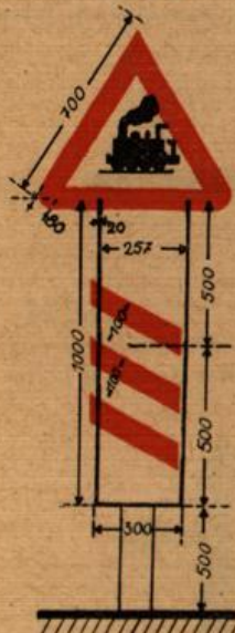
Balise à triple bande (gauche) devant un passage à niveau Dreistreifige Bake (links) vor un- beschränktem Übergang
