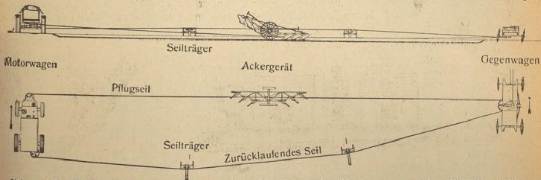
Schema (oben Seitenansicht, unten Aufsicht) zur Veranschaulichung der Geräteordnung beim elektrischen Pflügen.
