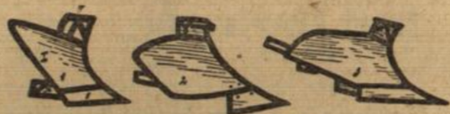
I = Streichblech, II = die Schar, III = Sohle, IV = Griesssäule
