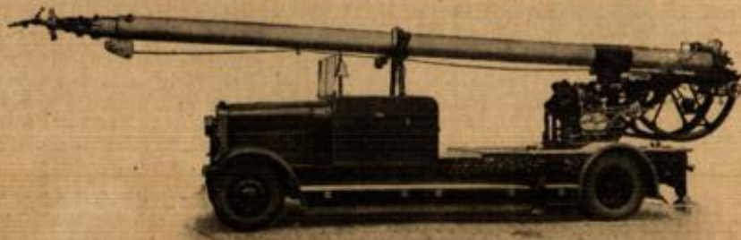
Der Mast in Fahrstellung
