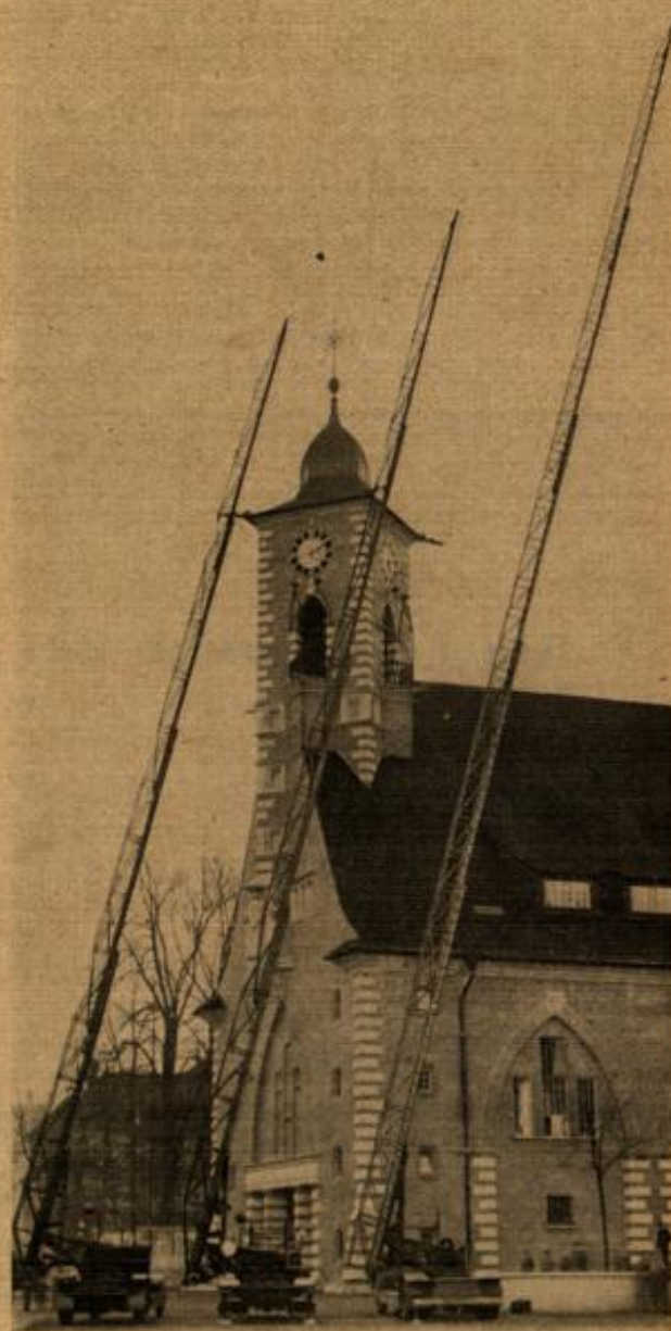
Rechts die vollständig ausgezogene 5 teilige Magirus-Ganzstahl-Feuerwehrleiter
