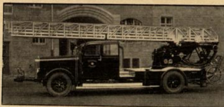
Eine der an die Feuerwehr Dresden gelieferten 6 Mercedes-Benz-Metz-Kraftfahrerdrehleitern, 30 plus 2 m Steighöhe.
