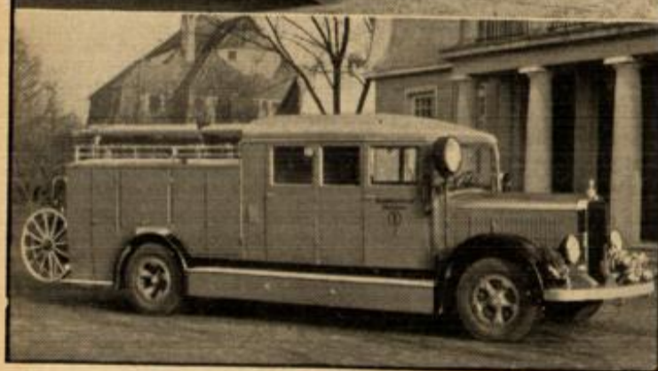
Oberes Bild: Mercedes-Benz-Metz-Kraftfahrerspritze. Wasserpumpenleistung 2000 bis 2500 Utr./min., Schaumleistung 2500 Utr./min. sowie Kohlenäureschnee-Löschanlage. Geliefert u. a. an die Firma E. Merck, Darmstadt, u. J. G. Farben-Industrie, Höchst a. M. Unteres Bild: Mercedes-Benz-Metz-Kraftfahrerspritze, 2500 Utr. Pumpenleistung. Schaumlöschanlage. Geliefert u. a. an Mannheim, Kassel, Nürnberg.
