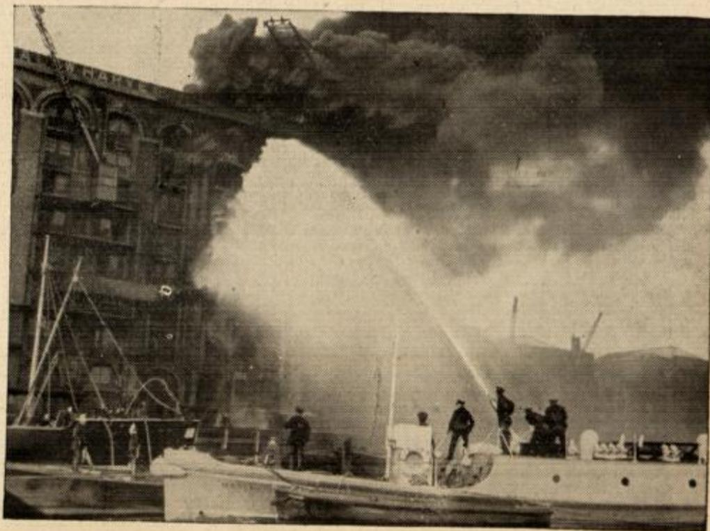
mühte danach theoretisch 39,5 at sein, wobei auf die einzelne Spritze 5,7 at entfallen. Der tatsächlich gemessene durchschnittliche Druck an den Spritzen (bei 500 l/min.) betrug 6,1 at, also eine recht gute Übereinstimmung mit der Theorie!
