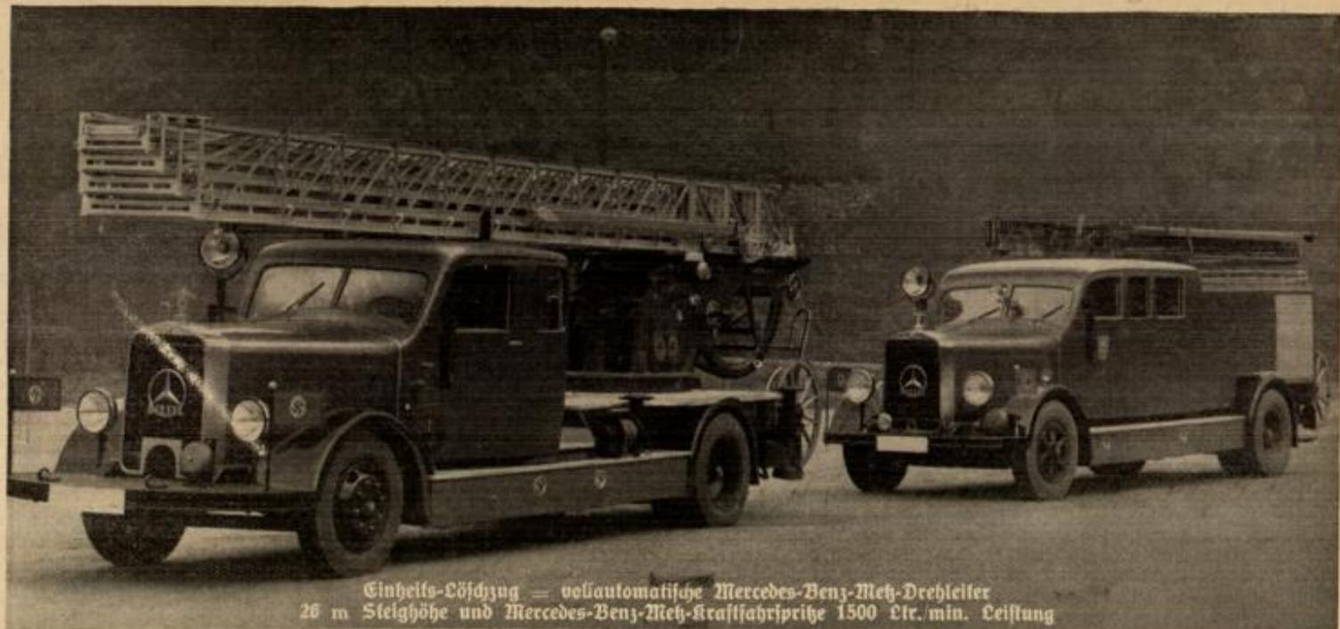
Einheits-Eöschzug = vollautomatische Mercedes-Benz-Meh-Drehleiter
