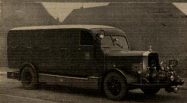
Mercedes-Benz-Meh-Schlauchtransportwagen mit Vorbaupumpe 1500 ltr./min.
