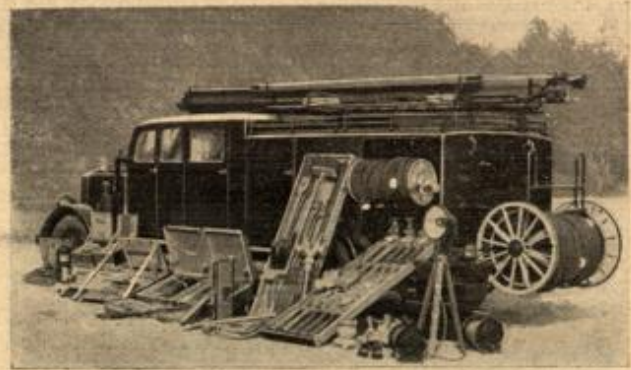
Bild 9: Geräte-Ausrüstung einer Einheits-Kraftfahrspitze
