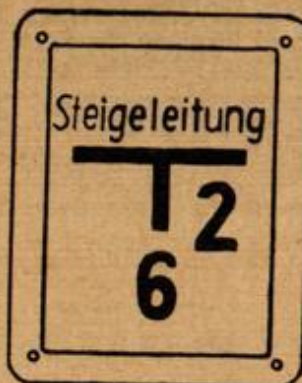
Schild für Steigeleitung mit Entfernungsangabe
