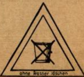
Schild für Raum, in dem sich Stoffe befinden, die nicht mit Wasser gelöscht werden dürfen
