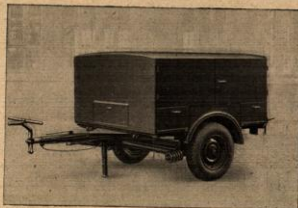
9. Einachsenanhänger für Schlauch- und Geräte-Transport, mit waagrechter Schraubenfederung
