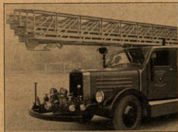
Abb. 5. Kraftfahrdrehleiter mit Vorbaupumpe 2500 l/min — 80 m, Bauart Metz.
