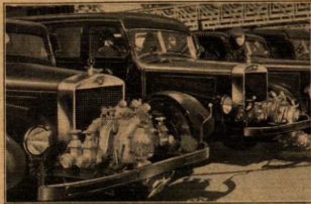
Abb. 4. Vorbau-Feuerlöschpumpen an den Fahrzeugen der Feuerlöschpolizei Dresden, Bauart Amag-Hilpert.
