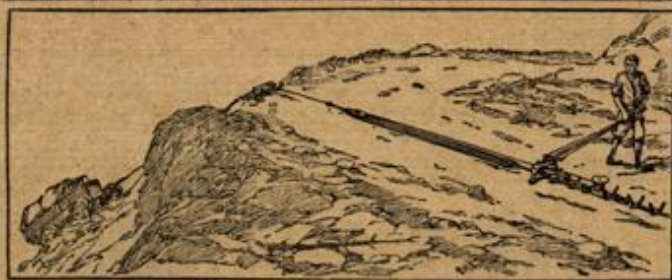
Bergung eines 5-Tonnen-Lastautos über eine Kante durch 5-Tonnen-Spillwinde mit automatischer Seilabfuhr und Aufwindung und Rantrolle
