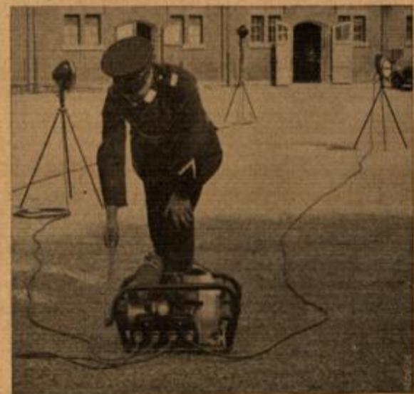
Abb. 4: Das benzin-elektrische Licht-Aggregat, mit dem 4 Scheinwerfer die ganze Nacht hindurch mit Strom versorgt werden können. Es leistet bis zu 600 Watt bei 24 Volt Spannung.
