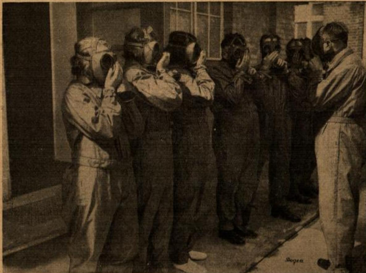
Dichtheitsprüfung beim Verpassen der Geräte
