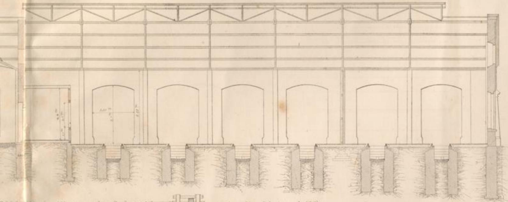
Schiebeuhne (von 6<sup>m</sup>) mit versenkter Grube 1 30
