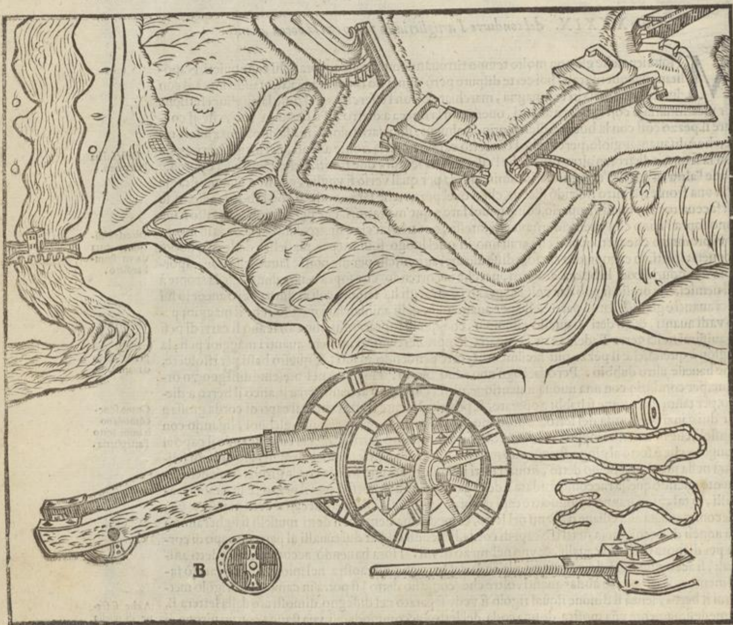
Auuertimento del modo per condurre il pezzo con la bocca a dietro.
