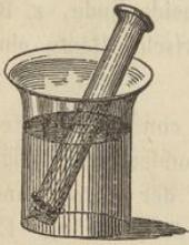
Giesst man z. B. in eine Glasröhre, welche unten mit thierischer Blase zugebunden ist, eine Lösung von Kupfervitriol und stellt dieselbe in ein Gefäss mit Wasser, so dass die Flüssigkeiten ausserhalb und innerhalb der Röhre gleich hoch sind, so wird
