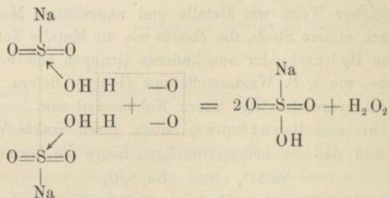
Wie aus dieser Gleichung ersichtlich ist, nehmen wir neben der Bildung von Wasserstoffperoxyd nicht eine primäre Bildung von pyroschwefligsaurem Natrium wie Bernthsen, sondern von Bisulfit an, welches letztere mit Ätznatron in das neutrale Sulfit übergeht.
