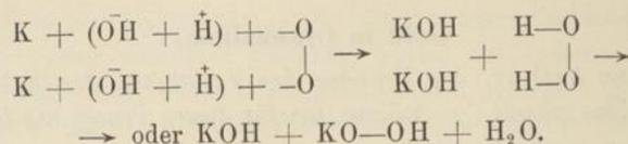
Dieser Prozeß wäre aber gar nicht bemerkbar, wenn nicht einerseits durch die Bildung von  $\text{KAu}(\text{CN})_2$ , d. h. von komplexen goldhaltigen Ionen  $\text{Au}(\text{CN})_2$ , andererseits durch das Wegfangen der K- bzw. H-Ionen durch den Sauerstoff der Nachschub der immer nur in sehr geringen Mengen in der Lösung vorhandenen Au-Ionen ermöglicht wäre.
