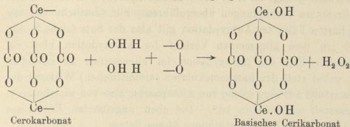
Diese primären Produkte der Autoxydation werden aber durch die nachfolgende Wirkung des Wasserstoffperoxydes auf die gebildete Ceriverbindung in der Weise verändert, daß ein Teil der letzteren durch das Wasserstoffperoxyd in die von Job isolierte und von ihm genau untersuchte Peroxydverbindung übergeht, ein Vorgang, welcher sich etwa durch folgende Umsetzungen verdeutlichen läßt:
