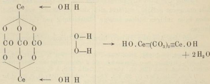
Sofern die von Job nachgewiesene Peroxydverbindung ein primäres Autoxydationsprodukt wäre, müßten auf 2 Atome Cer der Ceroverbindung 3 Atome Sauerstoff aufgenommen werden, wie dies Baur<sup>1)</sup> auf Grund seiner Messungen des absorbierten Sauerstoffs angenommen hat.
