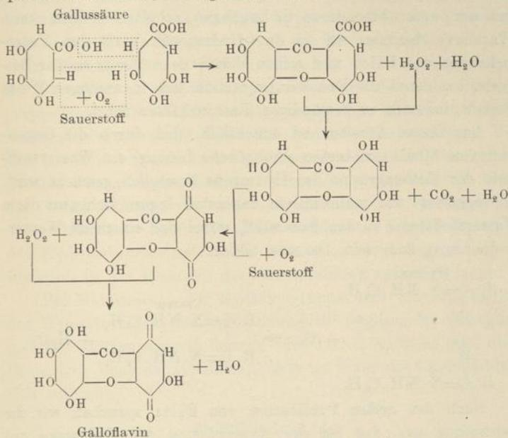
Es werden hiernach von 2 Mol. der Gallussäure unter obigen Bedingungen 2 Mol. Sauerstoff absorbiert und unter Mitwirkung des primär gebildeten Wasserstoffperoxyds wird Galloylflavin gebildet, das in Form des unlöslichen Kaliumsalzes sich der weiteren Wirkung des Luftsauerstoffs entzieht.
