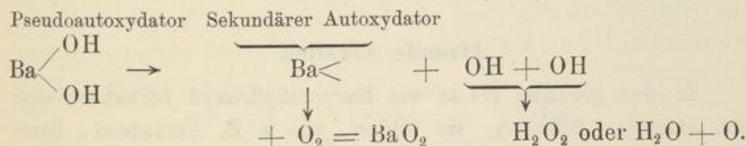
Diese Reaktion vollzieht sich mit merklicher Geschwindigkeit nur dadurch, daß das Baryum mit dem molekularen Sauerstoff das bei der herrschenden Temperatur beständige Baryumperoxyd bildet.
