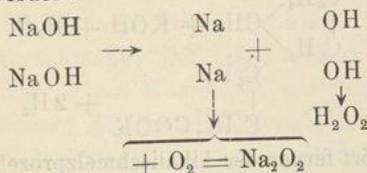
Hieraus ergibt sich die Natriumperoxydbildung als eine direkte Anlagerung von Sauerstoff an Natrium, die oxydierenden Wirkungen aber als eine Folge der Aufnahme von Hydroxylresten durch die oxydable Substanz, die begleitende Wasserstoffentwicklung als eine Wirkung des disponibel gewordenen Natriums auf das gebildete hydroxylhaltige Oxydationsprodukt, oder, bei
