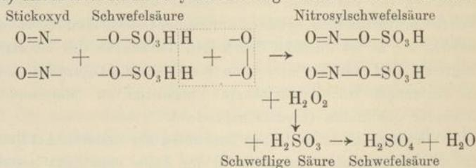
Der Kammerprozeß setzt sich demnach aus zwei konkurrierenden Autoxydationsvorgängen zusammen<sup>1)</sup>, von welchen je nach dem Zusammentritt des Stickoxyds mit molekularem Sauerstoff und der schwefligen Säure
