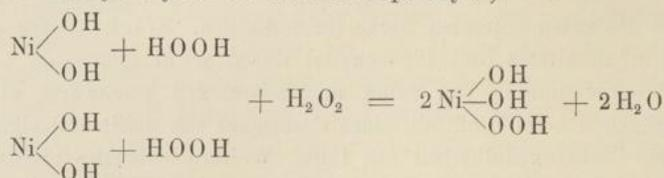
Selbstverständlich ist eine Verbindung wie das obige Nickelperoxyhydrat sehr unbeständig; insbesondere wird es, wie die meisten Peroxyhydrate, mit Wasser leicht unter Bildung von Wasserstoffperoxyd hydrolytisch spaltbar sein.
