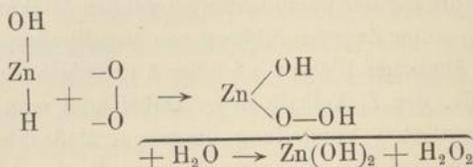
Die Bildung des Zinkhydroperoxydes kann auch direkt auf dem Ionenweg aus Zink-, Wasserstoff- und Hydroxylionen und Sauerstoff gedeutet werden. In ähnlicher Weise vollzieht sich die von Traube<sup>1)</sup> beobachtete Autoxydation des Zinks in alkalischer Lösung.
