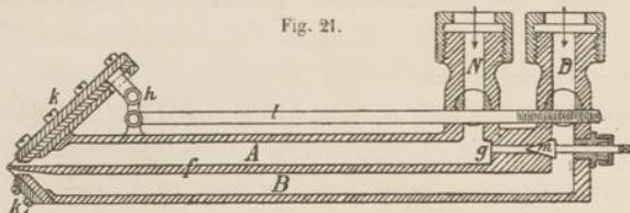
bezieh. Dampf in die beiden durch die Wand *f* in zwei Hälften getheilte Kammer *AB*. Die Ausströmung der Naphta wird durch Verstellung der Mundstückplatte *k* mittels Hebel *h* und Stange *l* während des Brennens geregelt; die Mundstückplatte *k*<sub>1</sub> für den Dampf wird von vorn herein festgestellt. Durch *g* kann der Dampf behufs Reinigung nach Zurückziehen des Kegels *m* auch in die Abtheilung *A* geleitet werden.
