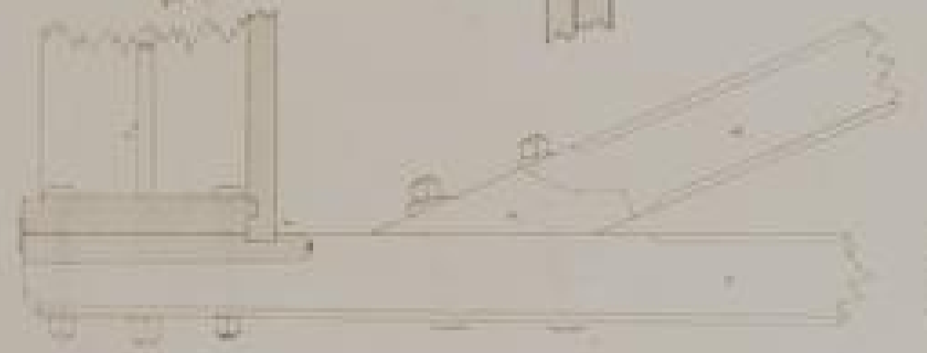
Fig. 3 Verbindung der Radflügel des Hochrades und des Arms
