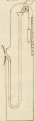
Bei solchen Dampfdruckmessungen ist das Manometer folgendermaßen eingerichtet: ein röhren Röhre von ungefähr 1" Weite und 3-4 Met. Höhe communicirt mit einem Kessel mit dem Kessel ist mit Quecksilber angefüllt, welches sich bei Verdampfung von Dampf so stellt, daß es die Differenz der Spannungen im Kessel & des Dampfdruckes anzeigt.
