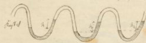
Läßt die ganze Quecksilberhöhe zwischen Kessel & Luft ist die höchste Lage der Röhre:  $h + h_1 + h_2 + \dots = H$
