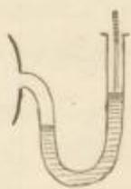
Ein Manometer in seiner einfachsten Form so wie es bei Niederdruckmessungen gebräuchlich ist, ist das folgende:
