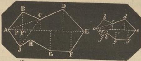
**Aufgabe.** Über eine gegebene Linie,  $ab$ , eine Figur zu konstruieren, welche einer andern Figur,  $ABC\dots J$ , ähnlich ist.
