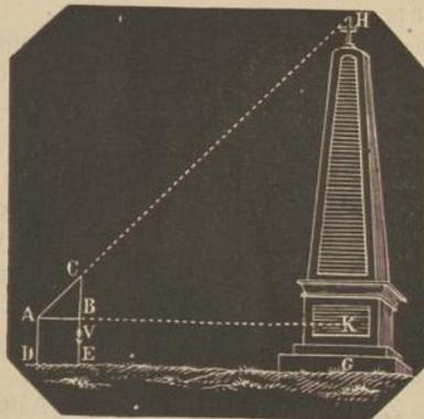
**Auflösung.** In einerlei Richtung und parallel mit HG stecke in D und E zwei Meßstangen ein, lege daran eine dritte Meßstange so, daß, wenn man über dieselbe hin visiert, die Visierlinie durch den Punkt H geht, messe dann DG, DE,
