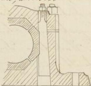
Es muß daher das Lager willkürlich drehbar in die Lagerplatte ein-gekittet sein, damit nicht schon die Läden abgerissen werden.
