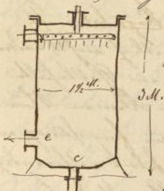
Für den unteren Gasrohr werden meistens nur 3 Zoll. für den obigen Gasrohr angegeben.
