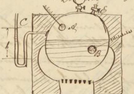
Um einen Druckgefäß füllen ich mit Wasser, entnehmen Gaszylinder und lese den Druck durch den Hahn E entnehmen. die Temperatur des Druckgefäßes messen wir durch ein Thermometer A, das Wasser auf einen B und die
