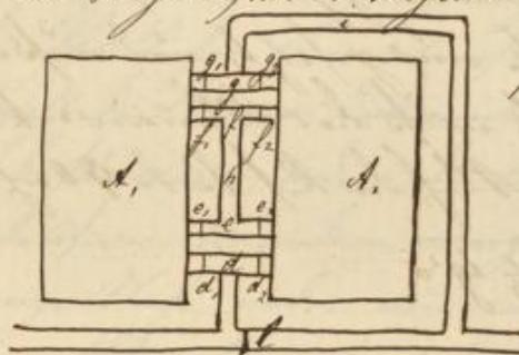
A, sind Kalksteinzäufe; d, d<sub>1</sub>, e, e<sub>1</sub>, f, f<sub>1</sub>, g, g<sub>1</sub> sind Gußplatte. Röhre dient dem d, d<sub>1</sub>, e, e<sub>1</sub>, so daß das Gas durch den Kalksteinzäuf. fällt und das Gas in d unterhalten, so daß es durch d<sub>1</sub>, f<sub>1</sub> in A strömen, so daß es durch e, e<sub>1</sub> und f, f<sub>1</sub> ausfließt. Der Kopf h schwimmt e mit f, l ist ebenfalls ein Röhrchen, der das Gas zwingt in den Kalksteinzäuf einzudringen.
