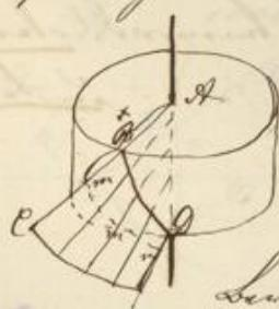
4. Gleichzeitig ist Klappenzahlung gleich der Anzahl der Klappen auf dem Mantel in einem Kreisumfang
