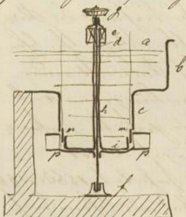
die Ax befindet sich in einer Röhre
