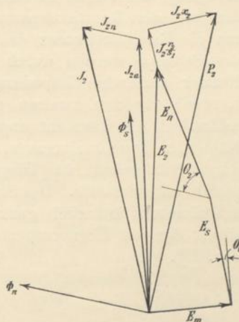
Fig. 40. Vektordiagramm der Kaskadenschaltung eines Induktionsmotors mit einem Scherbius-Kompoundmotor.
