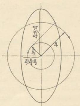
Fig. 3. Entstehung eines elliptischen Drehfeldes aus zwei gegenläufigen Kreisfeldern ungleicher Amplitude.
