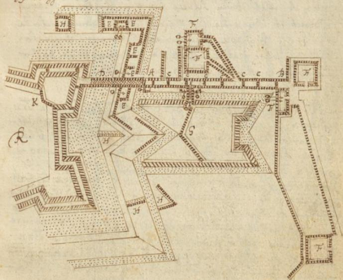
R. est le fort de la balle, A. B. est la sape, C. sont les Selindes de fassine, au dessous desquelles on passoit, D. est la Galerie po' aller au Bastion, E. sont les corde gardes et Batteries sur la contrescarpe, F. sont les corde gardes et Batteries aux Tranchées, G. est le détachement qui,
