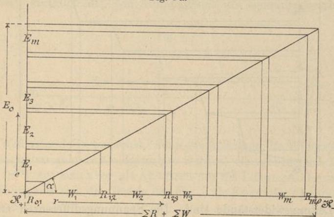
bedeuten sollen.\*) Die Kurve dieser Abhängigkeit ist also eine Gerade, vergl. Fig. 5 a. Die Neigung dieser Geraden gegen die Abszissenachse giebt ein Mass für die Stromstärke, denn es ist
