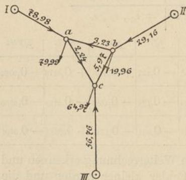
$R_{ab}$  von a nach b fließt, so ist die wahre Stromrichtung die entgegengesetzte von der, die unter der Wirkung der *EMK*'te  $\epsilon_a - \epsilon_b$  zustande kommen würde.
