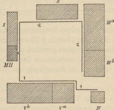
besser wäre es, wie es in der Figur gezeichnet ist, zwei Stränge zu verlegen, deren erster an I, II und III entlang geführt ist, während der andere nur die Gebäude V und IV versorgt, denn dann ist die grösste Entfernung in jedem der Stränge nur ungefähr halb so gross, wie in dem einen Stränge und die Berechnung wird entsprechend kleinere Querschnitte ergeben.
