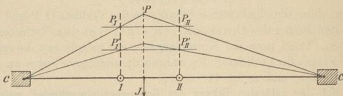
sie gegenüber den durch  $J$  hervorgerufenen Strömen vernachlässigbar sind. Die Kurve des Spannungsverlustes ist dann dargestellt durch den Linienzug  $CPC$ . Die Gleichheit der Spannungen an den Speisepunkten drückt sich in der Figur dadurch aus, dass die Verbindungslinie der Punkte  $P_I$  und  $P_{II}$  parallel zu  $CC$  ist. Wie sich nun auch die Belastung in dem einen Punkte ändern mag, die Aenderung der Kurve des Spannungsverlustes wird stets
