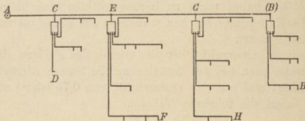
Sicherungen — unter Umständen auch der Ausschalter — wird überall, wo es die höheren Kosten nicht verbieten, gern angewendet, weil die Ueberwachung und Instandhaltung der Anlage hierdurch sehr erleichtert wird.
