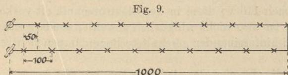
55 Watt, nämlich 11 Amp bei 5 Volt möglichst gleichmässig beleuchtet werden. Die Betriebsspannung soll 110 V betragen.
