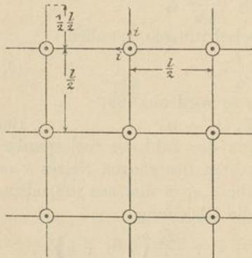
Die beiden Gleichungen (98) und (99) lehren, dass die günstigste Entfernung zweier Speisepunkte nicht — wie man nach den Ausführungen des § 46 vielleicht zu erwarten versucht war — mit dem Quadrate der Nutzspannung wächst, sondern nur mit der  $\frac{2}{3}$ ten Potenz, also der Nutzspannung noch nicht einmal proportional ist. Die Abhängigkeit der günstigsten Entfernung von allen anderen Grössen ist noch weit geringer.
