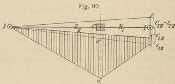
darstellt, lässt sich nämlich Fig. 90 in der Weise ableiten, dass man die nach der Darstellungsweise von Fig. 89 getrennt gezeichneten Anschlüsse in der Zentrale C vereinigt und die Spannungsverluste, da sie von den Speisepunkten aus gerechnet negativen Wert haben, nach unten abträgt, indem man, im Punkte II beginnend, zu den Geraden der ersten Figur Parallelen zieht. Es entsteht so der
