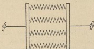
1. Alle Stromempfänger haben dieselbe Klemmenspannung, aber jeden durchfließt ein anderer Strom.
