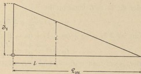
Leitung soll auf konstanten Querschnitt berechnet werden.
