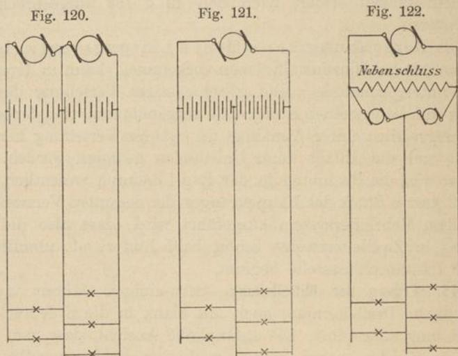
muss deshalb eine zweite Maschine hierfür aufgestellt werden, die aber im Vergleich zur ersten nur sehr klein zu sein braucht, so dass eine Ersparnis doch noch gemacht wird. Ein anderer Nachteil ist der, dass eine Betriebsunterbrechung der Batterie den Betrieb der ganzen Anlage unmöglich macht.
