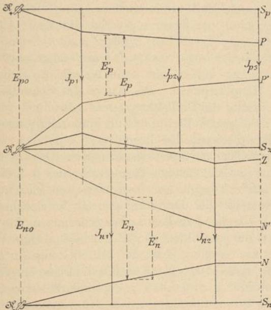
ung bringen; der Querschnitt der Mittelleitung ist hier gleich der Hälfte des Querschnittes der Aussenleitungen angenommen.
