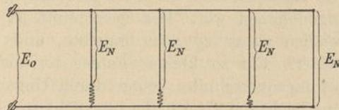
geeigneter Grösse (vergl. Fig. 37) vor jeden einzelnen Stromempfänger auf das normale Mass herabgedrückt werden soll. Auch auf diese Weise und unter diesen Voraussetzungen würde die Stromverteilung vor Bekanntsein der Widerstände angegeben werden können.
