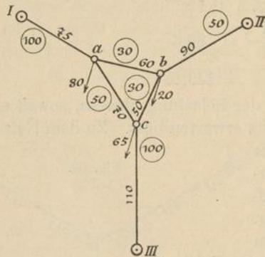
von nur drei Gleichungen noch nicht unbedingt zu empfehlen ist. Sind die Angaben einem fertig verlegten oder projektierten Netze entnommen, so stehen in den meisten Fällen ziemlich genaue Zahlen als erste Annäherungswerte zur Verfügung. Waren für das Projekt z. B. 2% zugelassen, so wird der Spannungsverlust bis zu den Knotenpunkten bei einer Betriebsspannung von 110 V ungefähr 2 V betragen; jedenfalls kann man die Zahl 2 als ersten
