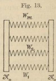
in der zweiten Figur sind die Widerstände zwischen zwei praktisch widerstandsfreien Schienen eingeschaltet zu denken. War früher bei der Hintereinanderschaltung die Stromstärke als gegebene Grösse aufzufassen, so ist es jetzt die Spannung an den Klemmen der Widerstände. Jedenfalls lässt sich von der Spannungsdifferenz zwischen den Enden der Widerstände sofort aussagen, dass sie für alle Widerstände dieselbe sein muss; unbekannt dagegen sind vorläufig die Ströme.
