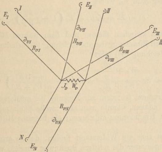
zeigt also nicht die mittlere Spannung an, sondern einen zu kleinen Wert. Soll das Instrument die mittlere Spannung anzeigen, so muss es nach derjenigen Spannung graduiert werden, die an den Spannungsmesserklemmen herrschen würde, wenn sein ursprünglicher Widerstand  $W_v$  um den Betrag  $\frac{R_v}{n}$  erhöht wäre. Bei der Graduierung muss also ein Widerstand von diesem Betrage zugeschaltet werden.
