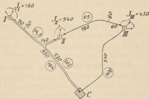
2. Zu einem Beispiel für die Rechnung auf Ausgleich von zwei Seiten sollen die in Fig. 95 niedergelegten Verhältnisse benutzt werden; die Figur unterscheidet sich von der vorigen durch Hinzufügung des Teiles C III II, die Leitungen sind auf die Spannungsverluste  $\epsilon_{om} = 2$  Volt und  $\epsilon_s = 12$  Volt berechnet. Die in der Rechnung nötigen Werte sind
