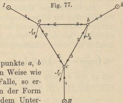
Behandelt man die Knotenpunkte  $a$ ,  $b$  und  $c$  für sich, jeden in derselben Weise wie den Knotenpunkt  $a$  im vorigen Falle, so erhält man je drei Gleichungen von der Form der Gleichungen (44), aber mit dem Unterschiede, dass die Spannungsdifferenzen im Zähler verschieden sind. Die Verbindung der Gleichungen ergibt deshalb je eine Gleichung mit drei Unbekannten und das ganze System für alle drei Knotenpunkte lautet:
