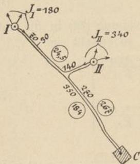
**107. Beispiele.** 1. Beispiel für die Berechnung auf Ausgleich von einer Seite. Gegeben sei der durch Fig. 94 dargestellte Teil eines Netzes. Die maximalen Belastungen sind
