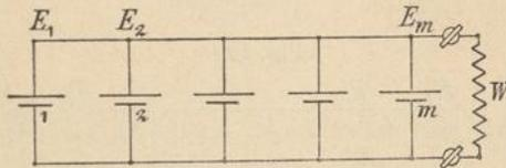
kann die Entladung unmöglich völlig gleichmässig sein, denn die ersten Zellen sind durch einen grösseren Widerstand geschlossen als die letzten, die dem Widerstande  $W$  nahe sind. Eine deutlichere Erklärung liefert folgende Ueberlegung: Alle Zellen haben dieselbe EMK  $E$  und denselben inneren Widerstand  $W_A$ , der Strom, der die einzelnen Zellen durchfliesst, lässt sich ausdrücken als
