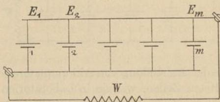
in Fig. 105 gezeichnet ist. Die Leitungen zwischen den einzelnen Zellen müssen also von den gegeneinander versetzten Hauptklemmen aus proportional der Stromstärke, und da diese der Zellenzahl proportional ist, proportional der Zahl der Zellen abnehmen.
