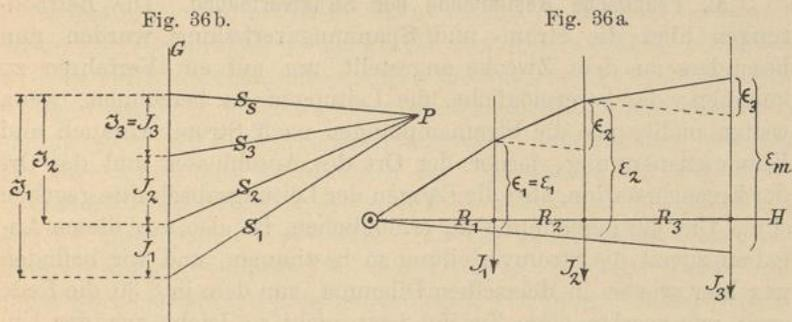
Die in den Abständen  $R = 1$  von den Abzweigpunkten an errichteten Ordinaten, begrenzt durch die Kurve des Spannungsverlustes, geben ein Mass für die Grösse der Leitungsströme an. Dies führt zu einer bequemen graphischen Konstruktion der Kurve des Spannungsverlustes, wenn die Abzweigströme gegeben sind:
