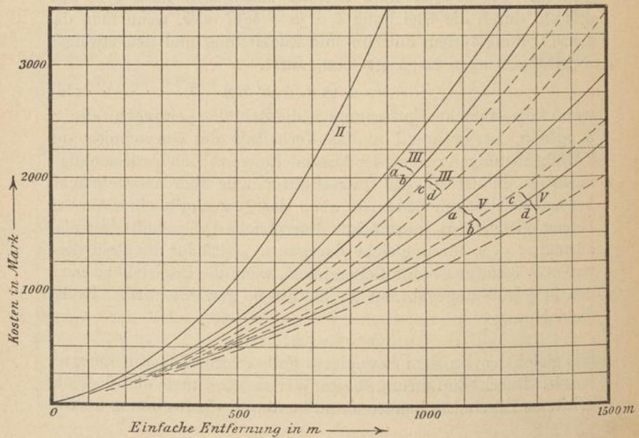
Fig. 117. Kosten der Leitungen in Abhängigkeit von der Entfernung bei unterirdischer Verlegung.
