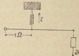
so gross zu wählen, dass das System im Gleichgewicht ist; oder es könnte auch umgekehrt bei gegebenem Hebelarm  $R$  und Momente  $\epsilon$  das Gewicht  $J$  gesucht werden. Um den Vergleich noch weiter zu führen, kann man annehmen, dass die Kraft  $\epsilon$  (im Falle der Fig. 20) die Feder eben bis zur Elastizitätsgrenze beanspruche. Die Grösse  $J$  darf dann den berechneten Wert, sowohl
