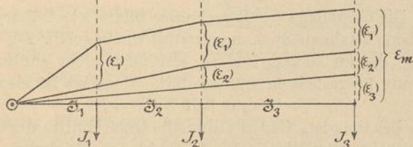
nungsverlust erscheint als das Drehmoment, das das ganze System im Gleichgewicht hält. Bezeichnet man in Analogie mit früherem die Produkte  $J\mathfrak{R}$  als Strommomente, so ergibt sich der Satz:
