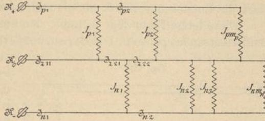
Systeme sind praktisch ausgeführt worden. Die Zwischenleitungen im Fünfleitersystem sind als positive und negative Zwischenleitung und Nullleitung zu unterscheiden.
