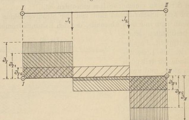
die Bedingung, dass der Gesamthalt der über der Geraden  $I II$  liegenden Fläche gleich dem der unterhalb der Geraden liegenden sein muss.
