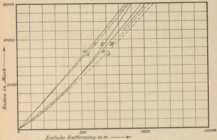
Fig. 118. Kosten der Leitungen in Abhängigkeit von der Entfernung bei unterirdischer Verlegung.
