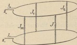
föhrlicherer Darstellung gezeichnete Form, und man kann diese Leitung einen geschlossenen einfachen Leitungsstrang nennen. Die Stromzuführungspunkte sollen Speisepunkte genannt werden.
