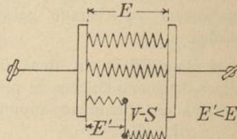
8. Die Ausschaltung eines Stromempfängers muss durch Unterbrechung erfolgen.
