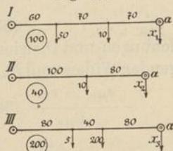
Zur Bestimmung der Stromverteilung in diesen Leitungssträngen ist der Querschnitt gleichgültig und braucht nach § 85 nicht berücksichtigt zu werden; ferner ist es bequemer mit den halben Längen, d. h. den gemessenen Entfernungen zu rechnen, man erhält dann die richtige Stromverteilung, aber nur die Hälfte des Spannungs-
