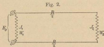
gibt nun das Joulesche Gesetz Aufschluss, welches aussagt, dass die in einem Widerstande  $R$  durch den Strom  $J$  während der Zeit  $T$  entwickelte Wärmemenge  $\mathfrak{B}$  gleich ist
