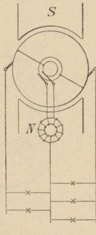
Um eine Regulierung zu ermöglichen, bedarf es der Einschaltung von Widerständen oder einer Zusatzmaschine in der Mitteleitung.
