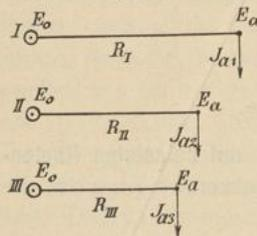
§ 82 beziehen und den Knotenpunkt  $a$  mit dem Speisepunkte niederer Spannung des dortigen Falles vergleichen. Die Verzweigung ist dann in drei unvollkommen geschlossene einfache Leitungsstränge aufgelöst, bei denen aber die Abzweigströme (oder Leitungsströme)  $J_{a1}, J_{a2}$  und  $J_{a3}$  noch unbekannt und ebenso der Spannungsabfall  $E_0 - E_a$  (vergl. Fig. 76) unbekannt ist. Nur die Summe der Ströme  $= J_a$  ist bekannt und von
