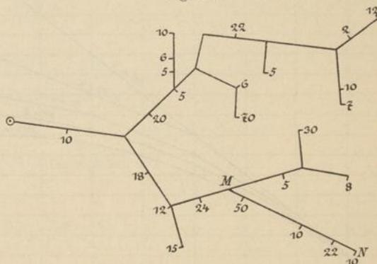
dem einfachen Leitungsstrange, so verfügen, dass die bei freier Wahl möglichen Unzweckmässigkeiten ausgeschlossen sind. Im vorliegenden Falle haben wir es aber mit einer noch grösseren Zahl von Willkürlichkeiten zu thun, da man in jedem mehrfach belasteten abgezweigten Strange, wie z. B. dem Strange  $MN$ , den vom Abzweigpunkte ( $M$ ) aus noch verfügbaren Spannungsverlust, der schon beliebig gewählt werden konnte, noch beliebig teilen kann.
