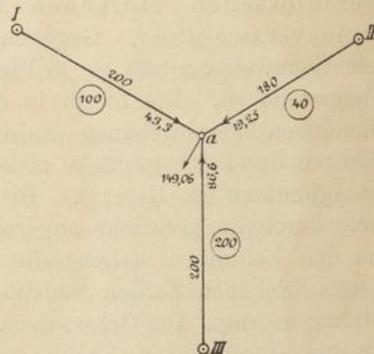
$21,5 + 5,56 + 122,0 = 149,06$  Amp zugeführt, und es ist dann die Spannung  $E_a$  tatsächlich gleich den Spannungen  $E_I = E_{II} = E_{III}$ . Diese Zufuhr findet in Wirklichkeit aber nicht statt; sie muss des-
