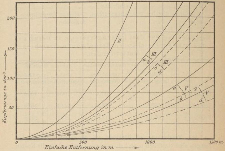
Fig. 116. Kosten der Leitungen in Abhängigkeit von der Entfernung
