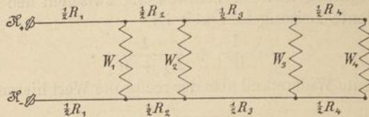
gestellten einfachen Leitungsstrang mit parallel geschalteten Stromempfängern, die aber räumlich auf eine gewisse Strecke verteilt sind, während in dem in § 36 zuerst behandelten Falle alle Stromempfänger von denselben Punkten abgezweigt waren.
