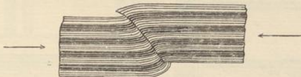
Abb. 28. Wirkung mäßigen Druckes auf Prisma Abb. 27. Erzeugung einer Bruchüberschiebung nach erfolgter Biegung. Überschiebungsfläche ca. 45^\circ gegen Richtung des Druckes geneigt. Maßstab 1:2. Nach Daubrée .
