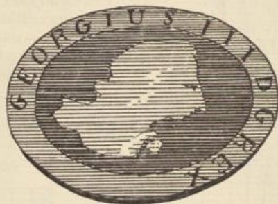
Abb. 20. Quetschung einer Münze mit dem Bildnis Georgs des III. unter einem Walzwerke erinnert an gewisse analoge Formveränderungen von Versteinerungen (Trilobiten etc.)
