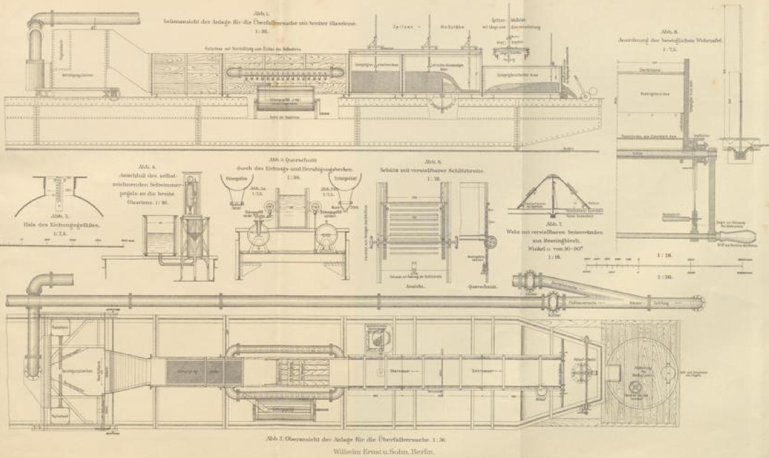
Abb. 2. Oberansicht der Anlage für die Überfallversuche. 1:20.
