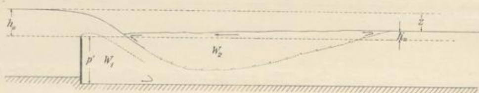
Abb. 8. Querschnitt durch einen wassergefüllten Strahl mit verdecktem Fuß.
