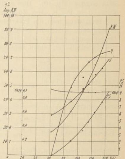
Fig. 15. Äußere Charakteristik und Arbeitskurven für  $n = 2000$ .
