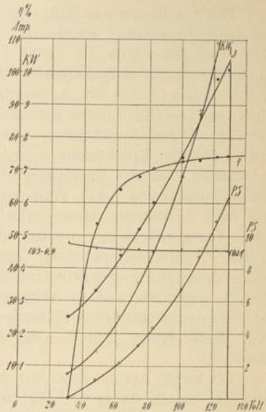
Fig. 13. Äußere Charakteristik und Arbeitskurven für  $n = 1200$ .
