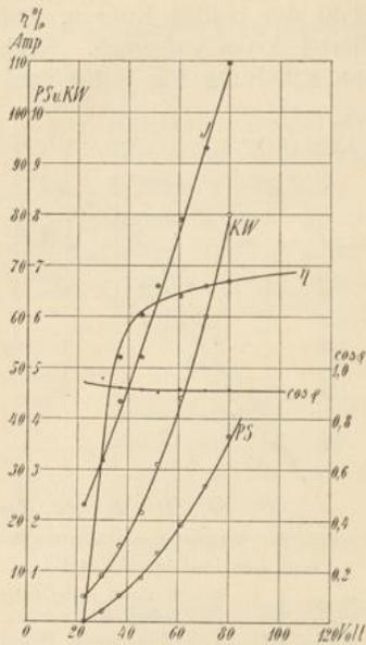
Fig. 12. Äußere Charakteristik und Arbeitskurven für  $n = 800$ .
