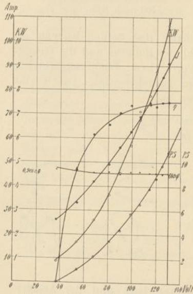
Fig. 14. Äußere Charakteristik und Arbeitskurven für  $n = 1400$ .
