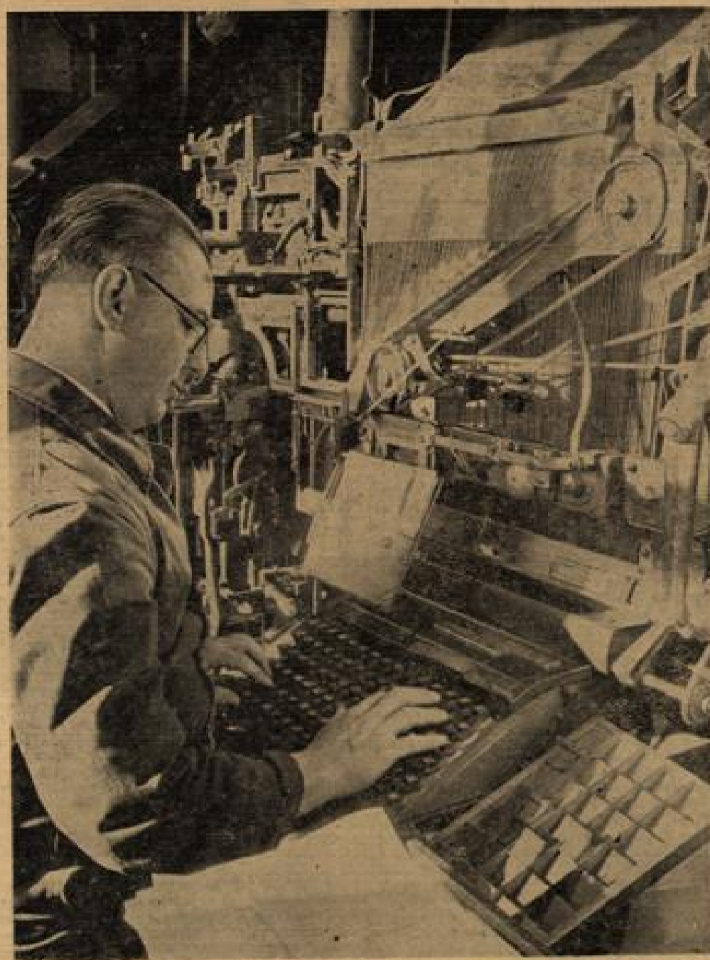
Gutenbergs schwarze Kunst fand ihre höchste Vervollkommnung in der Setzmaschine. Hier fügt sich im ratternden Rhythmus der Arbeit Buchstabe zu Buchstabe, Zeile zu Zeile, bis die Zeitung fertig ist. Aufnahmen: Dr. Paul Wolff & Tritschler, Frankfurt a. M.
