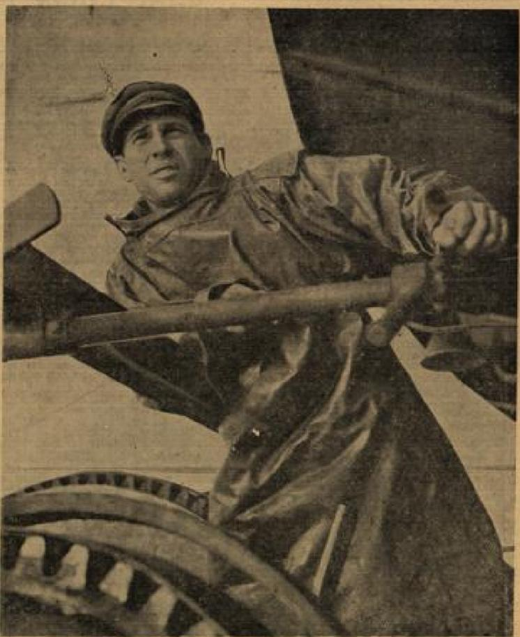
Zwei bis vier Stunden wird das Netz geschleppt. Dann wird der Befehl zum Aufholen gegeben. Rasselnd holt die Winde die Stahltrossen ein. Der Mann an der Winde muß aufpassen, damit die Hebel schnell bedient und mögliche Schäden vermieden werden. (Gremmler)
